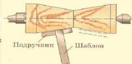
Рис. 2. Вытачивание конуса с установкой подручника на заданный угол
